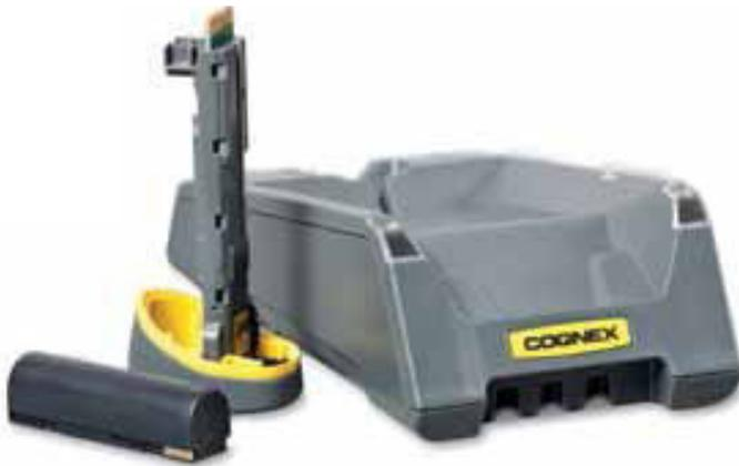
Die kabellosen Lesegeräte der DataMan 8050 und 8600 Serien verfügen über eine Reichweite—bis zu 30 m—mit einer großen Speicherkapazität, damit Codes auch offline oder außerhalb des Arbeitsbereichs gelesen werden können. Die Basisstation ist mit standardmäßigen Ethernet-, USB- und RS-232-Kabeln kompatibel.
